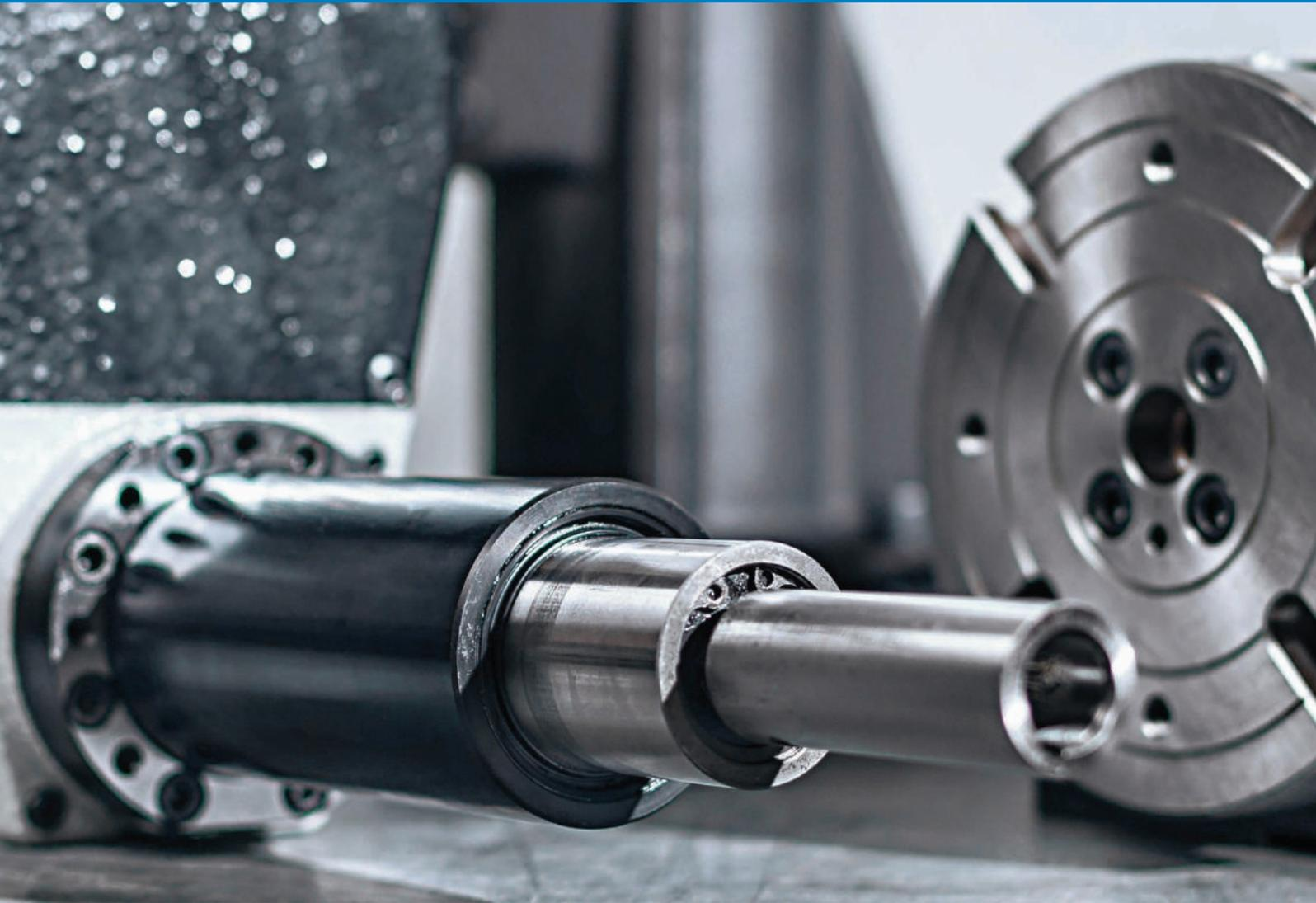
BOHREINHEITEN / DRILLING UNITS
